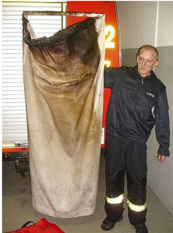
Der durch den Brand zerstörte mobile Rauchverschluss. Aber er hat seinen Zweck erfüllt gehabt und mit Sicherheit zur Rettung der Kinder beigetragen.
